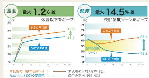
試験方法：人が寝た状態で背中・腰・尻が接する箇所に温湿度センサーをつけて測定を開始。5分後にファンのスイッチを入れそのまま25分間測定を継続。敷ふとんの上にも本製品を使用した場合と未使用時（敷ふとんのみ）の場合で比較。
